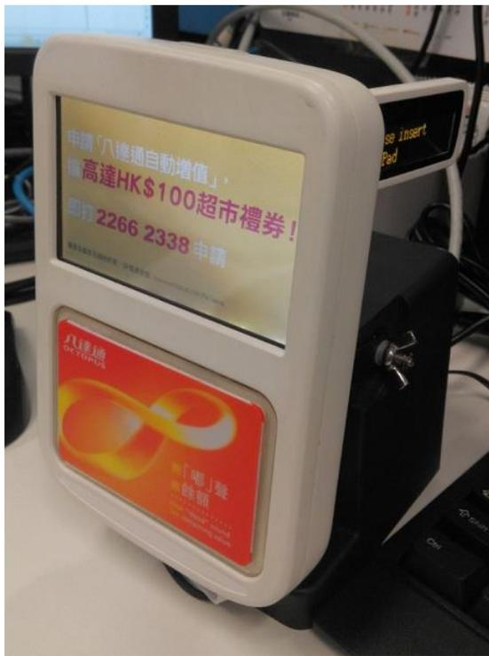
Figure 1 NRR 獨立式 (零售)八達通處理器(後螢幕顯示型號)
