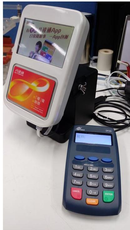
Figure 2 NRR 獨立式 (零售)八達通處理器和 PAX SP20
